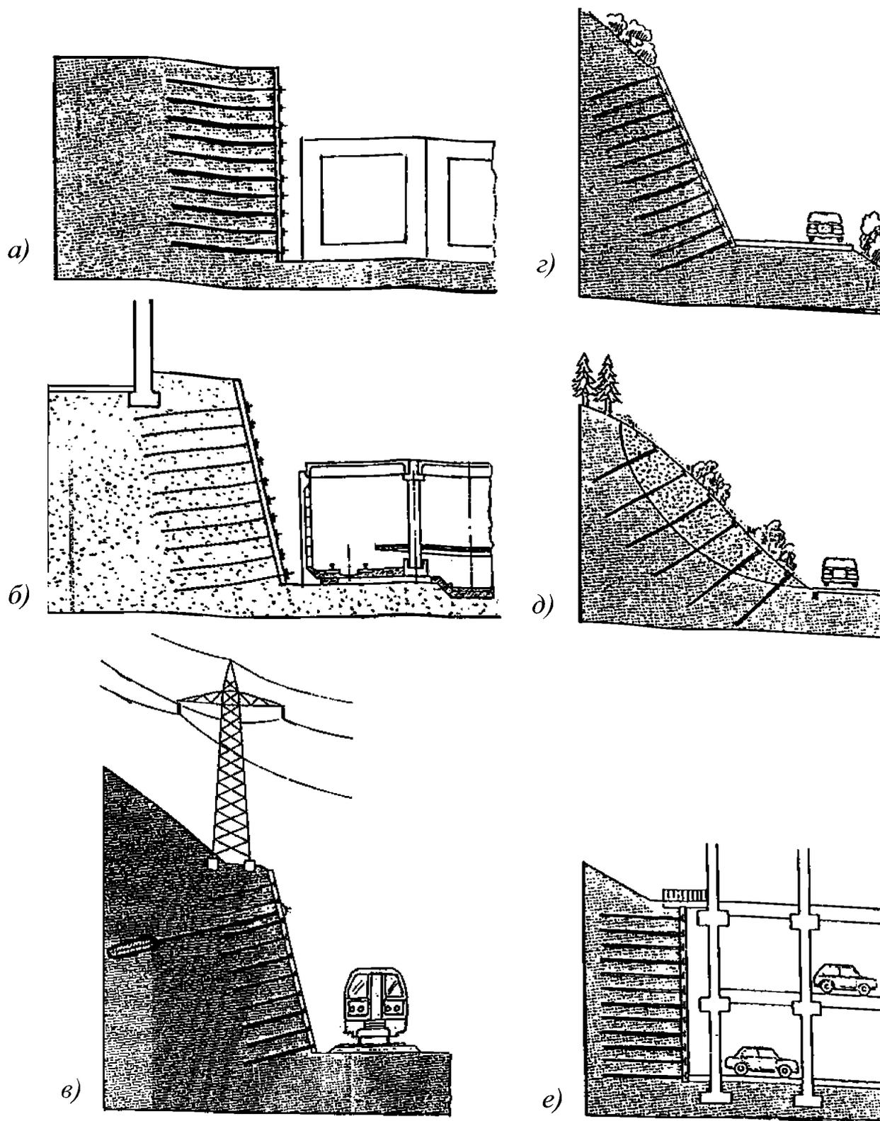
а) крепление вертикальной стены котлована; б) крепление откоса котлована;
