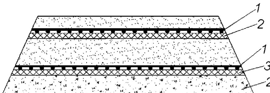
1 – армирующая сетка АНК; 2 – слой дренирующего грунта; 3 – геотекстильный материал
