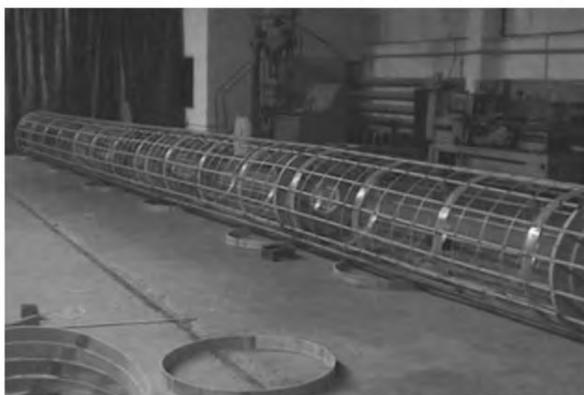
Рисунок 8.29 – Каркас буронабивной сваи из АНК-С в сборе
