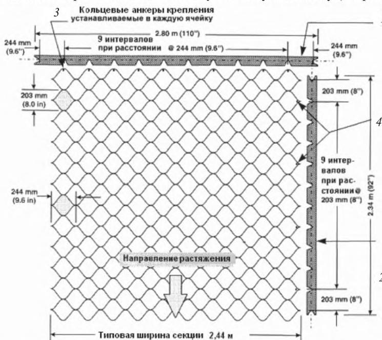
1 – верхняя кромка модуля георешетки; 2 – боковая кромка модуля георешетки;
