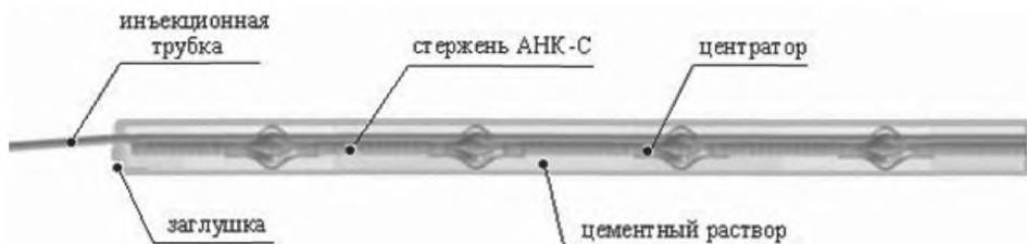
Рисунок 8.34 – Конструкция армирующего элемента из АНК-С
