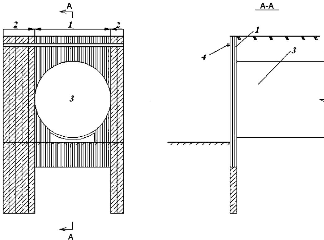
1 – сваи ограждения с каркасами из АНК; 2 – сваи ограждения с каркасами из стальной арматуры;
