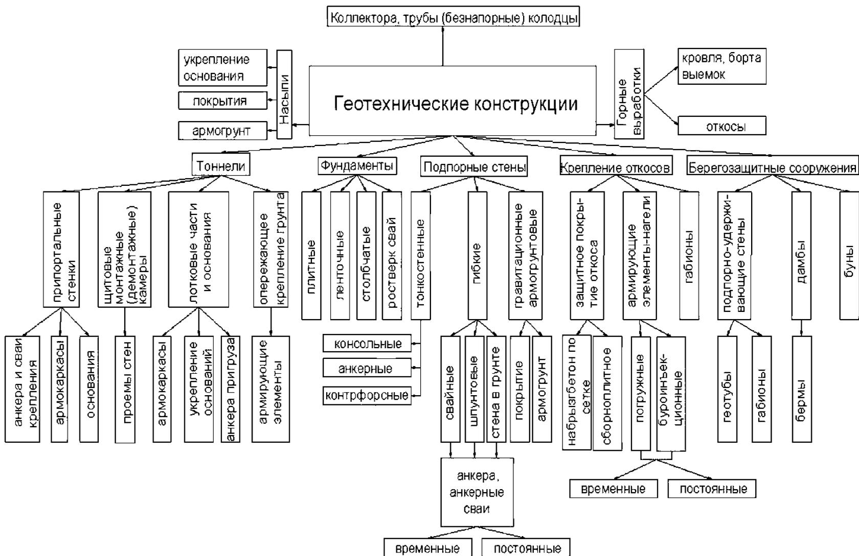
Рисунок 8.1 – Геотехнические конструкции с возможным применением АНК
