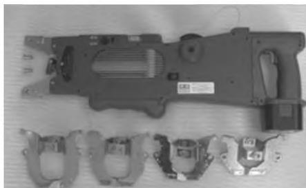
Рисунок 6.4 – Общий вид автоматического пистолета для вязки арматуры
