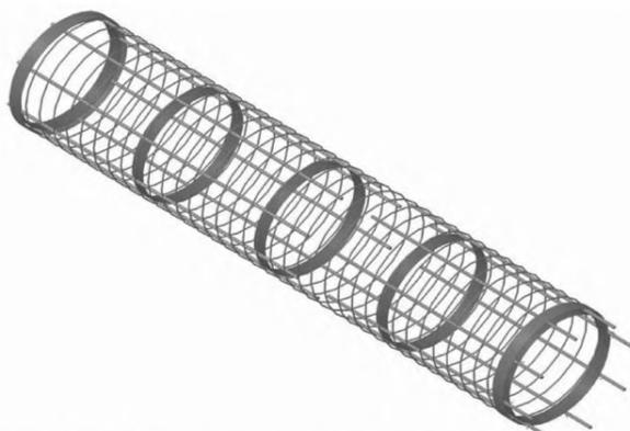
Рисунок 8.28 – Конструкция каркаса буронабивной сваи из АНК
