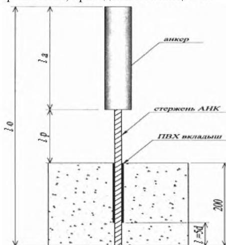
Рисунок Г.2 – Схема установки стержня в бетон
