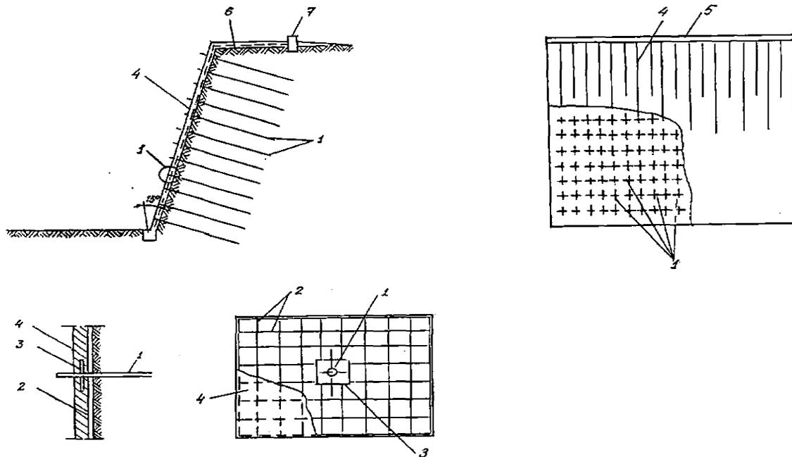
1 – армирующие стержни АНК; 2 – сетка из АНК; 3 – упорная пластина; 4 – слой набрызг-бетона;
