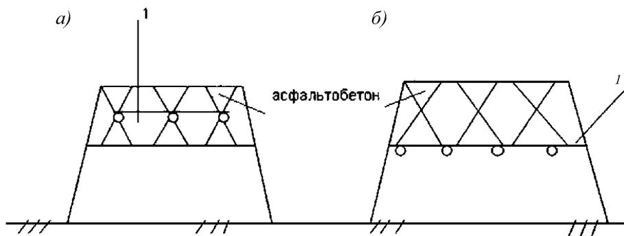
а) сетка АНК в составе асфальтобетонного покрытия;
