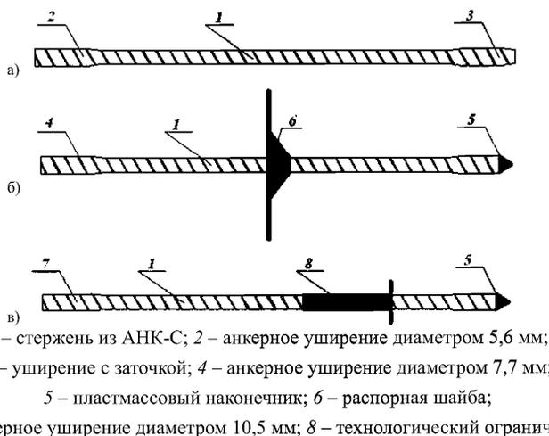
Рисунок 7.3 – Конструкции гибких связей из АНК-С
