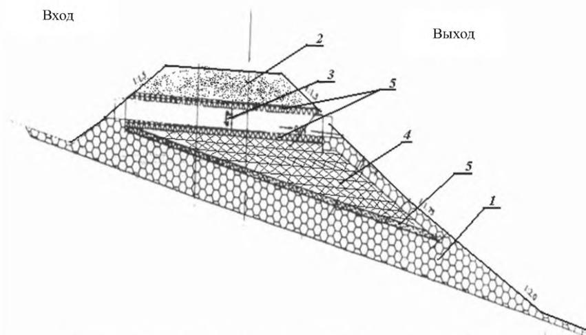
1 – фильтрующая насыпь (первый ярус); 2 – насыпь второго яруса;
