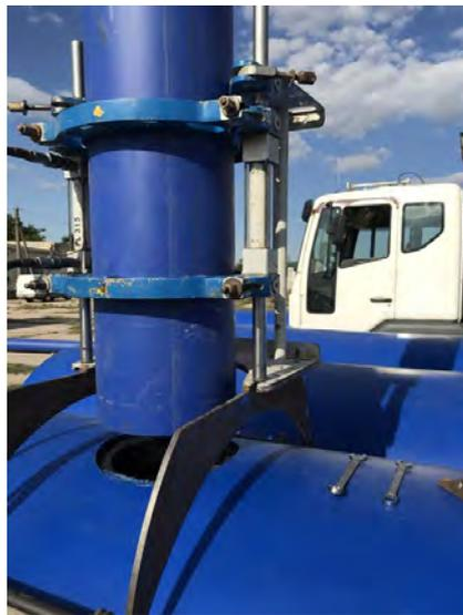
Технология ИНКАТ – комплекс мероприятий по выполнению врезки патрубков для изготовления равнопрочных, неравнопроходных тройников-отводов в ПЭ трубы ГОСТ 18599-2001, ГОСТ Р 58121.2
