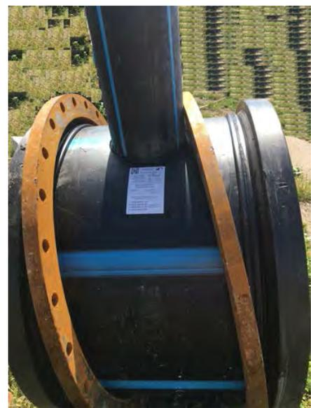
С помощью технологии ИНКАТ возможно изготавливать напорные тройники и врезки сверхкомпактного размера, в том числе с врезкой нескольких патрубков.
